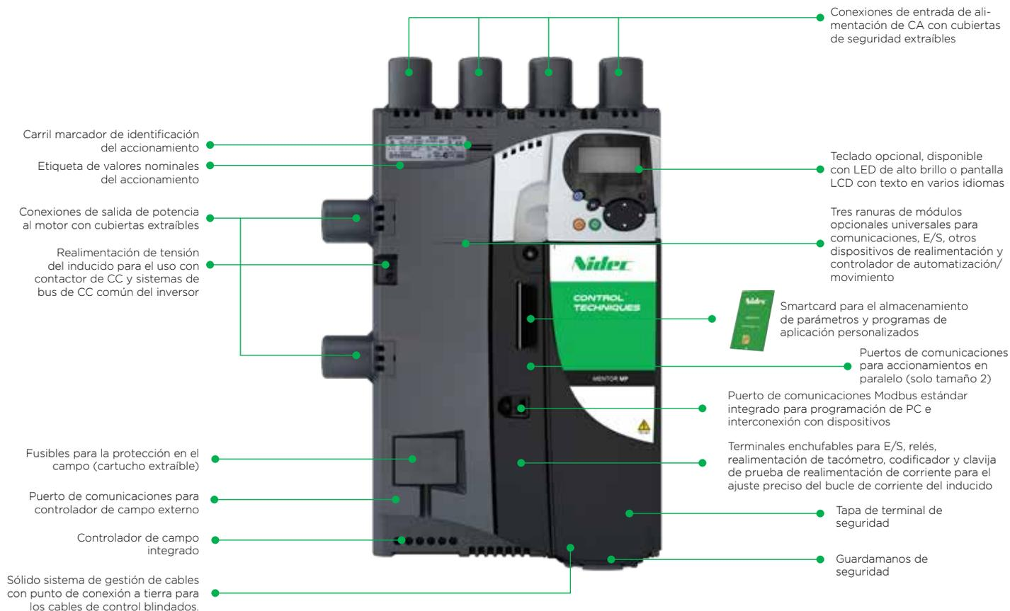
Diseñado para facilitar la configuración y la puesta en servicio
