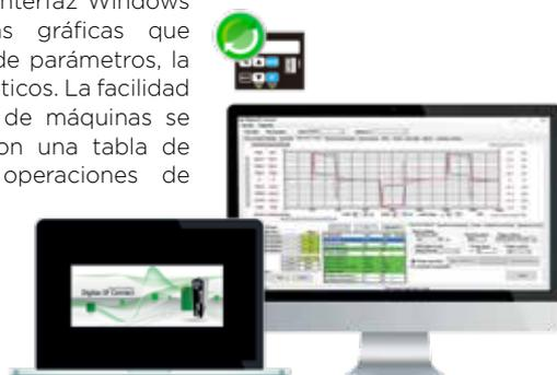
Con una configuración y sintonización sencillas, Digitax SF ofrece elevadas prestaciones servo con un solo clic de botón. Para aplicaciones exigentes, una abundante selección de filtros que amortiguan las resonancias magnéticas y suprimen las vibraciones de punta que pueden configurarse con facilidad en Digitax SF Connect con la ayuda del análisis de frecuencia FFT.
